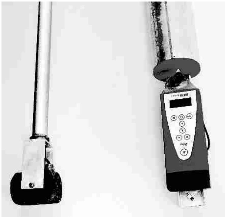
Abb. 1 Ultraschallmessgerät (links) und Lasersensor (rechts)
