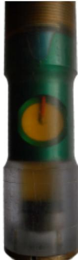
Abb. 1 Rotierender Ultraschallgeber des Bohrlochscanners im Ölbad
