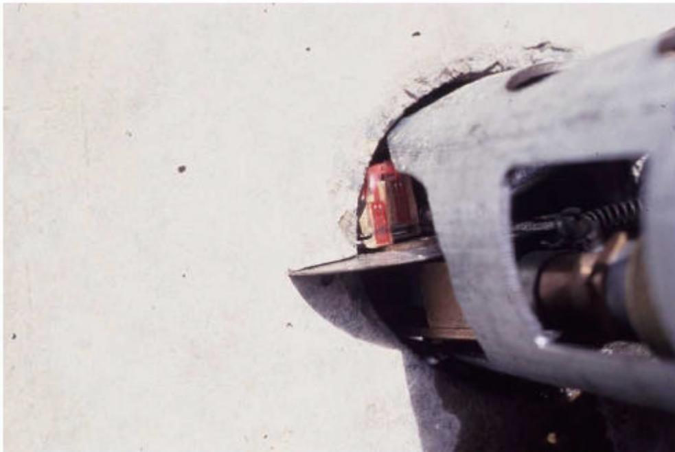
Abb. 1 Schlitzsonde am Mund eines Bohrlochs
