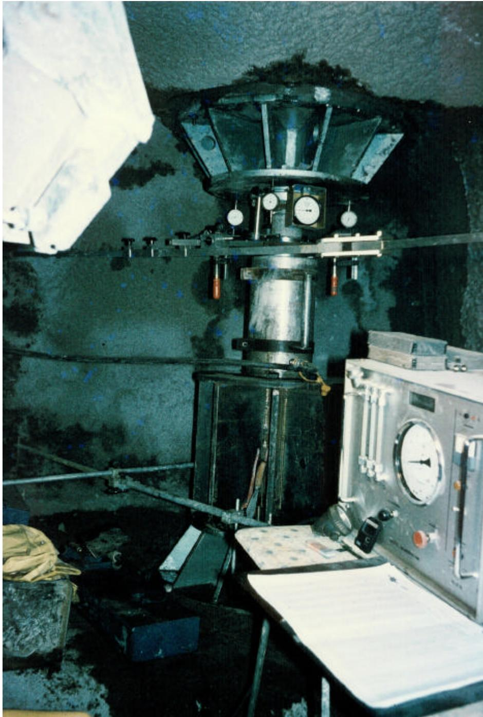
Abb. 7 Lastplattenversuch im Rollenbergtunnel, Vertikalversuch
