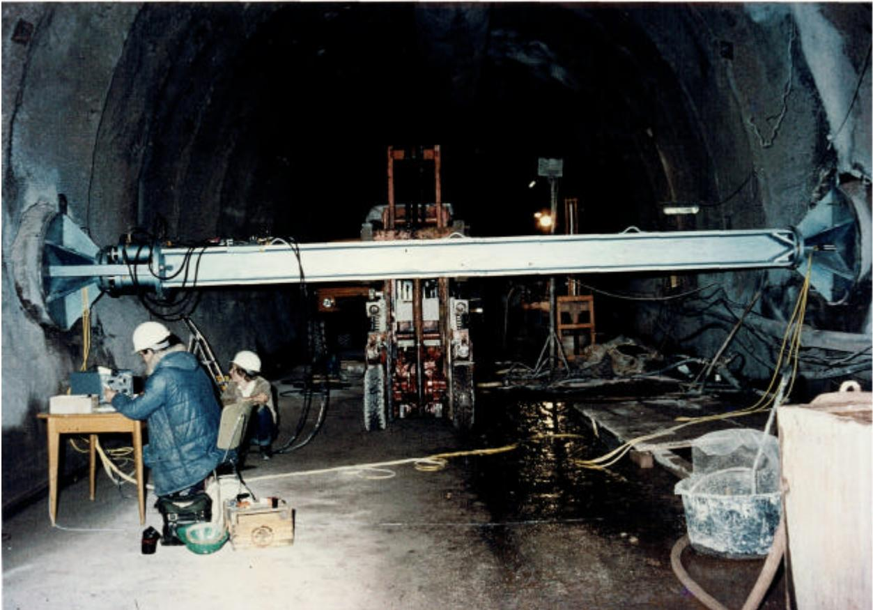
Abb. 5 Lastplattenversuch im Landrückentunnel, Horizontalversuch
