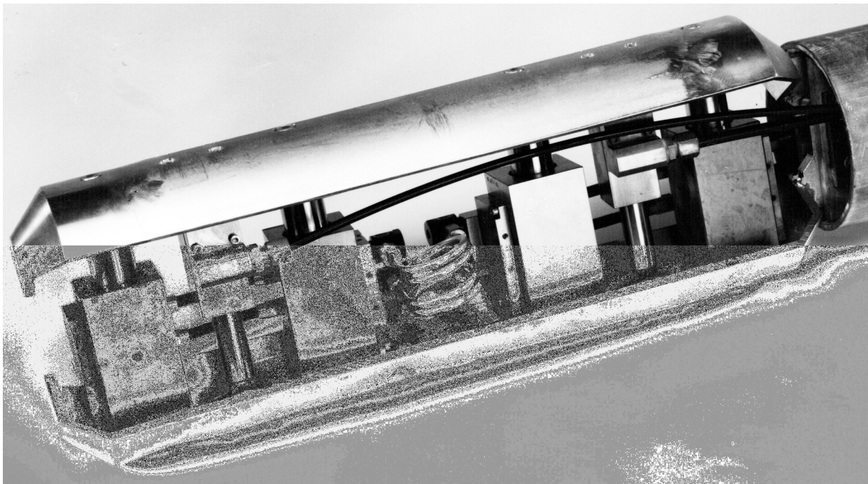
Fig 3 Dilatomètre rigide diamétral d'Ettlingen ESDS II/146: Coque de charge, vérins et capteurs de déplacement
