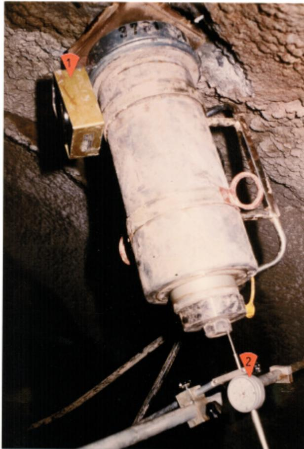
Fig 1 Dispositif de traction à tirant monté avec une cellule de charge (1), dont la limite d'erreur est plus petite d'un % par rapport à la valeur finale et une montre-compteur mécanique (2) d'une précision de lecture de  $\pm 0,01$  mm.
