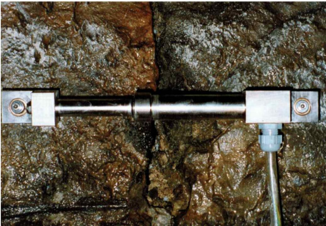
Fig 1 Fissuromètre type FE avec une distance mutuelle de 250 mm des touches mobiles
