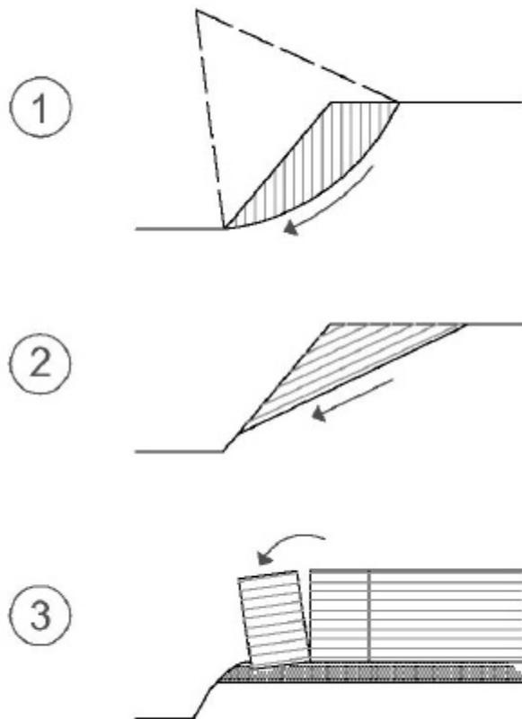
Fig 1 Mécanismes de mouvement différents dans le développement aux talus
