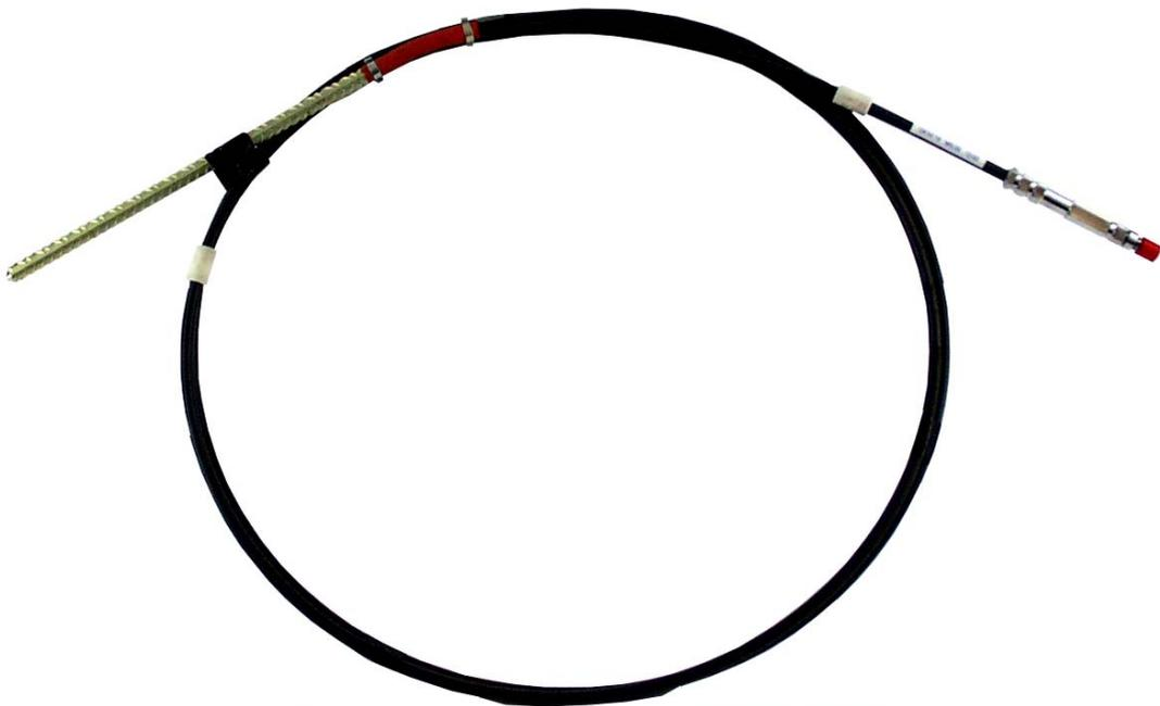
Fig 2 Extensomètre en état emballé, prêt pour l'installation, enroulé sur une bobine d'un diamètre de 1,2 m
