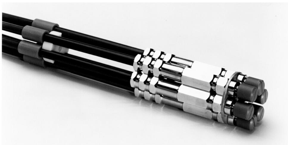
Fig 4 Extensomètres à 6 points du type GKSE 6/16 B, se composant de plusieurs extensomètres à 1 point avec plaque de montage pour installation noyée dans les forages
