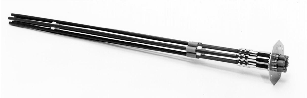
Fig 3 Extensomètre à 6 points avec plaque de montage et fixation en plastique. Pour une mesure à distance des capteurs de déplacement sont vissés directement sur la tête de mesure.
