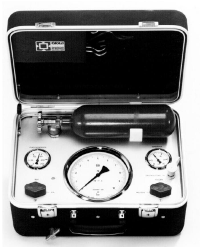
Fig 4 Régulateur de débit d'air commandé à la main, type T1, ALR, avec bouteille d'air comprimé intégrée
