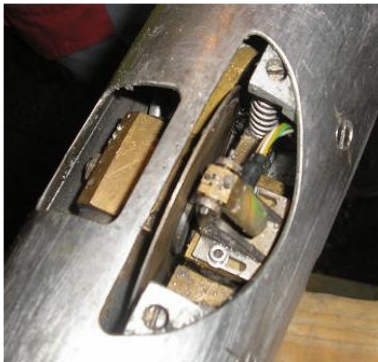
Fig. 2 Capteur d'allongement à côté de la lame de scie à diamant
