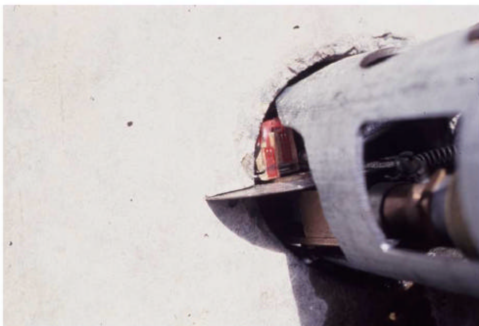
Fig. 1 Sonde d'entaille de forage (borehole slotter) à la tête du forage
