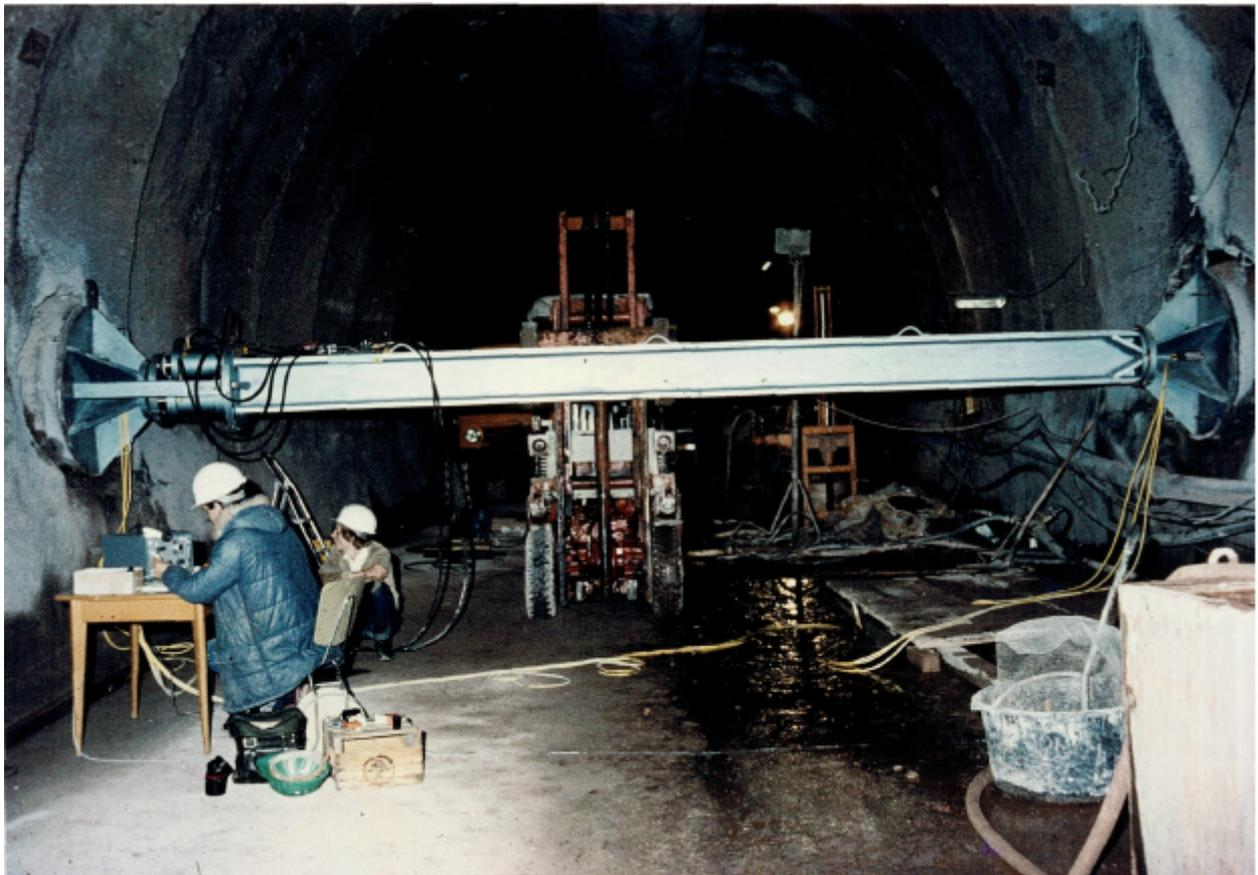
Fig 5 Essai de charge sur plaque dans le tunnel Landrücken, essai horizontal
