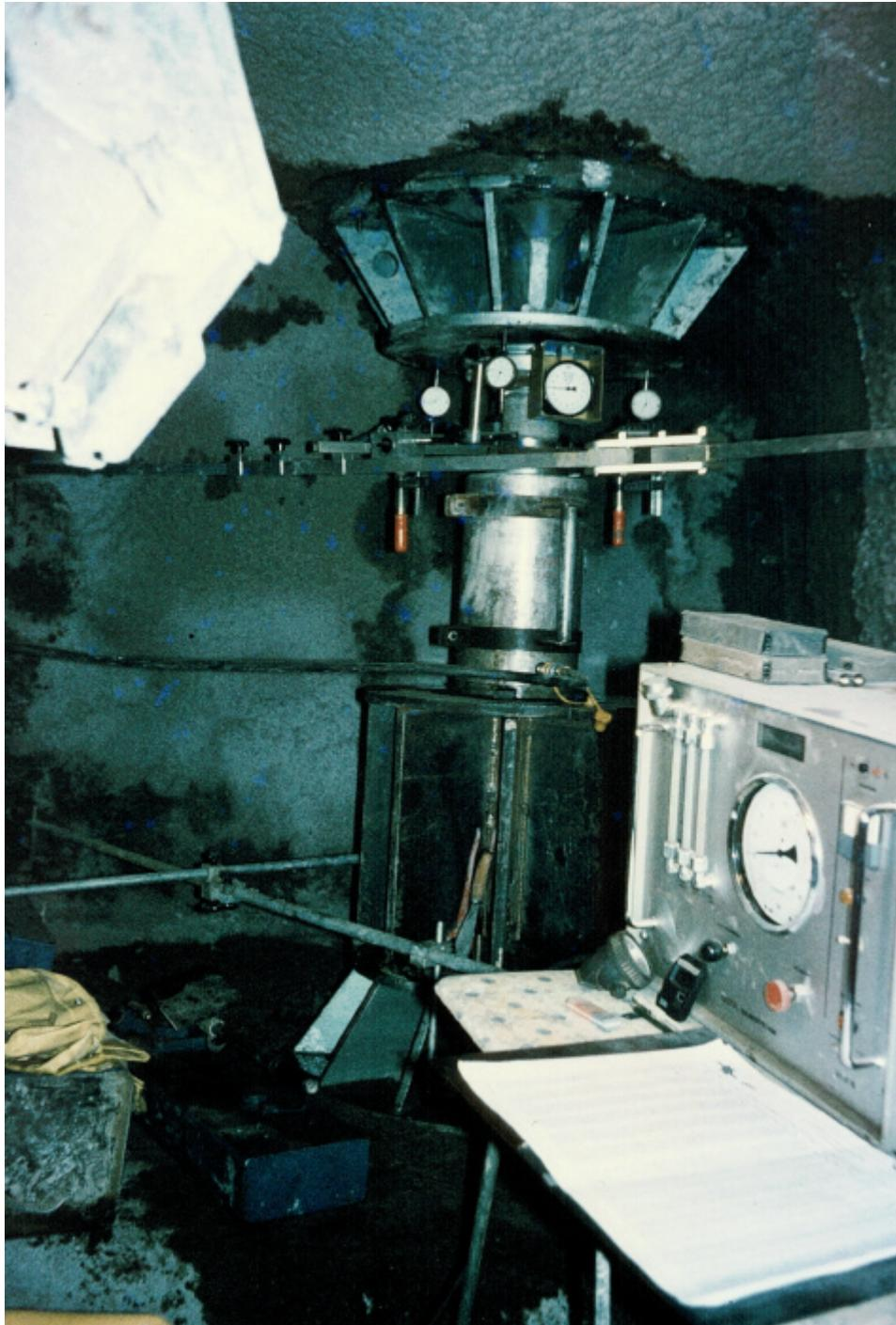
Fig 7 Essai de charge sur plaque dans le tunnel Rollenberg, essai vertical
