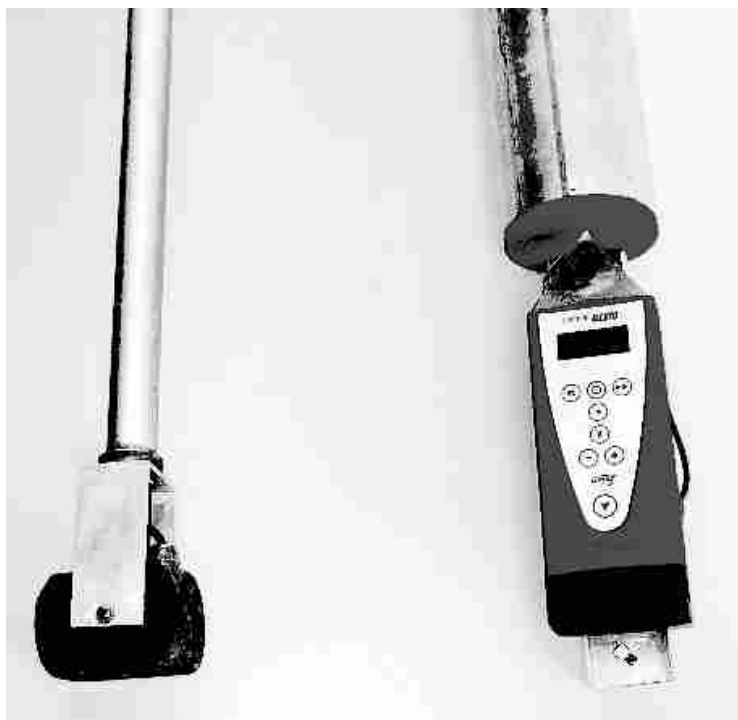
Fig 1 Instrument ultrason (à gauche) et capteur laser (à droite)
